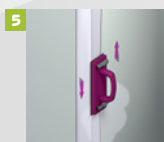
5 Pokriti traku tankim slojem gipsane mase i ostaviti da se osuši. Neravnine izravnati brusnim papirom min. granulacije 200
